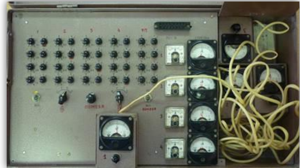
Внешний вид оригинального прибора «Гомеостат» Ф.Д. Горбова (60-70е гг.)
