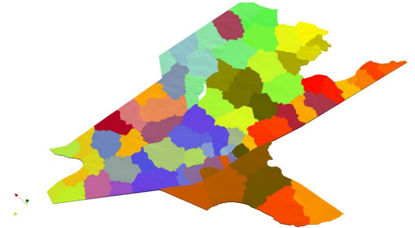
Пример декомпозиции области на 64 процессора
